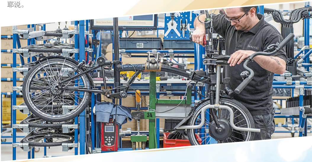
▼英国布朗普顿自行车生产车间内,工人正在组装折叠自行车产品。 克里斯·拉特克里夫摄(影像中国)
